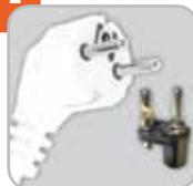
Неразборная литая вилка удлинителей ТМ UNIVERSAL изготовлена из пластика ПВХ рецептуры ОМ-40 (такой же материал используется для изготовления внешней оболочки провода). При изготовлении вилки используется никелированный цельнолатунный штифт стойкий к механическим нагрузкам, который не деформируется при эксплуатации, в отличие от полого или пластикаполненного штифта; никелевое покрытие защищает штифт от окисления.
