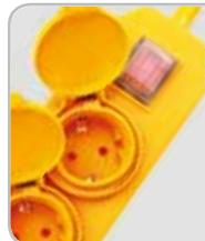
Удлинитель снабжен подпружиненными крышками, которые защищают гнезда розеток и обеспечивают их мгновенное закрытие после удаления вилки прибора-потребителя из розетки, без дополнительных усилий. Наличие выключателя со световой индикацией позволяет отключать приборы, не вынимая вилки из штепсельных гнезд. Защищен колпачком от попадания влаги и пыли.
