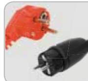
Провод марки ПВС армирован неразборной литой вилкой, выполненной в цвет провода, а марки КГ – разборной каучуковой вилкой со степенью защиты IP44. При изготовлении вилок используется никелированный цельнолатунный штифт.
