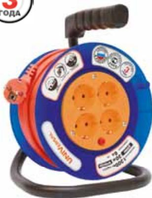
Удлинитель силовой У6-014, У10-014 являются самыми компактными удлинителями серии. Диаметр корпуса всего 190 мм. В отличие от более габаритных «собратьев» по серии, корпус этого удлинителя цельнолитой, что значительно повышает его стойкость к механическим и ударным нагрузкам. Стойка изготовлена из сварной стальной трубы диаметром 18 мм и толщиной стенки 1 мм. Для удобства переноски удлинителя предусмотрена эргономичная ручка.
