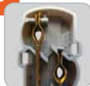
Контакты, изготовленные из латуни, и внутренняя вставка сконструированы таким образом, чтобы исключить неупругую деформацию контактов в процессе эксплуатации, то есть, после извлечения вилки из розетки удлинителя контакты возвращаются в первоначальное состояние. Предусмотренная конструкция обеспечивает надежный электрический контакт на протяжении всего срока службы удлинителя.
