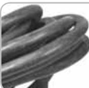
**Провод 100 % ГОСТ.** Провод на удлинителях изготовлен в соответствии с ГОСТ Р. КГ-провод: Температура окружающей среды от -50°С до +40°С. Радиус изгиба кабеля, не менее 8 наружных диаметров. Кабель устойчив к многократным изгибам. Устойчив к воздействию солнечных лучей.
