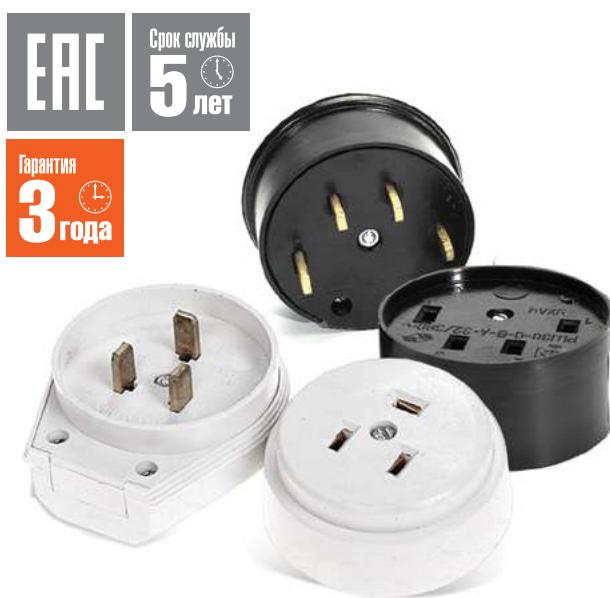
Штепсельные розетки и штепсельные вилки предназначены для подсоединения электротехнических устройств к трехфазной или однофазной сети переменного тока напряжением соответственно 250/380 В с потребляемой мощностью до 7 кВт и током до 32 А.
